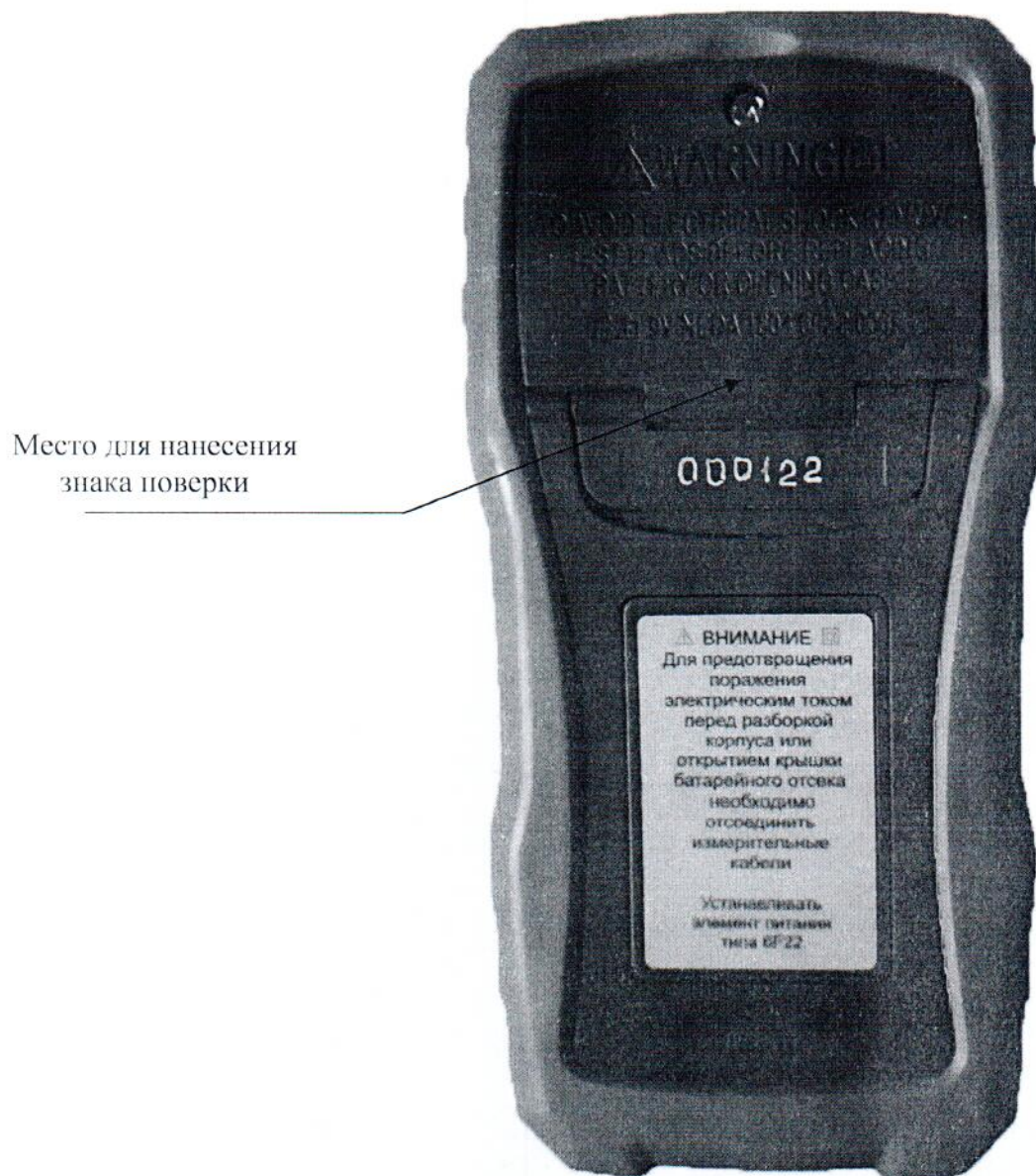
Рисунок 2.1 – Схема с указанием места для нанесения знака поверки (изображение носит иллюстративный характер)
