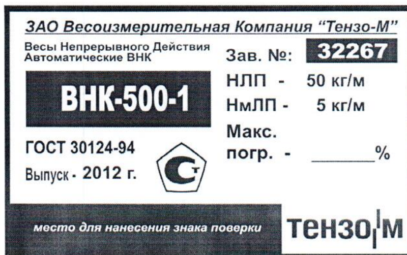
Рисунок 6 - Место нанесения знака поверки на маркировочной табличке весов ВНК
