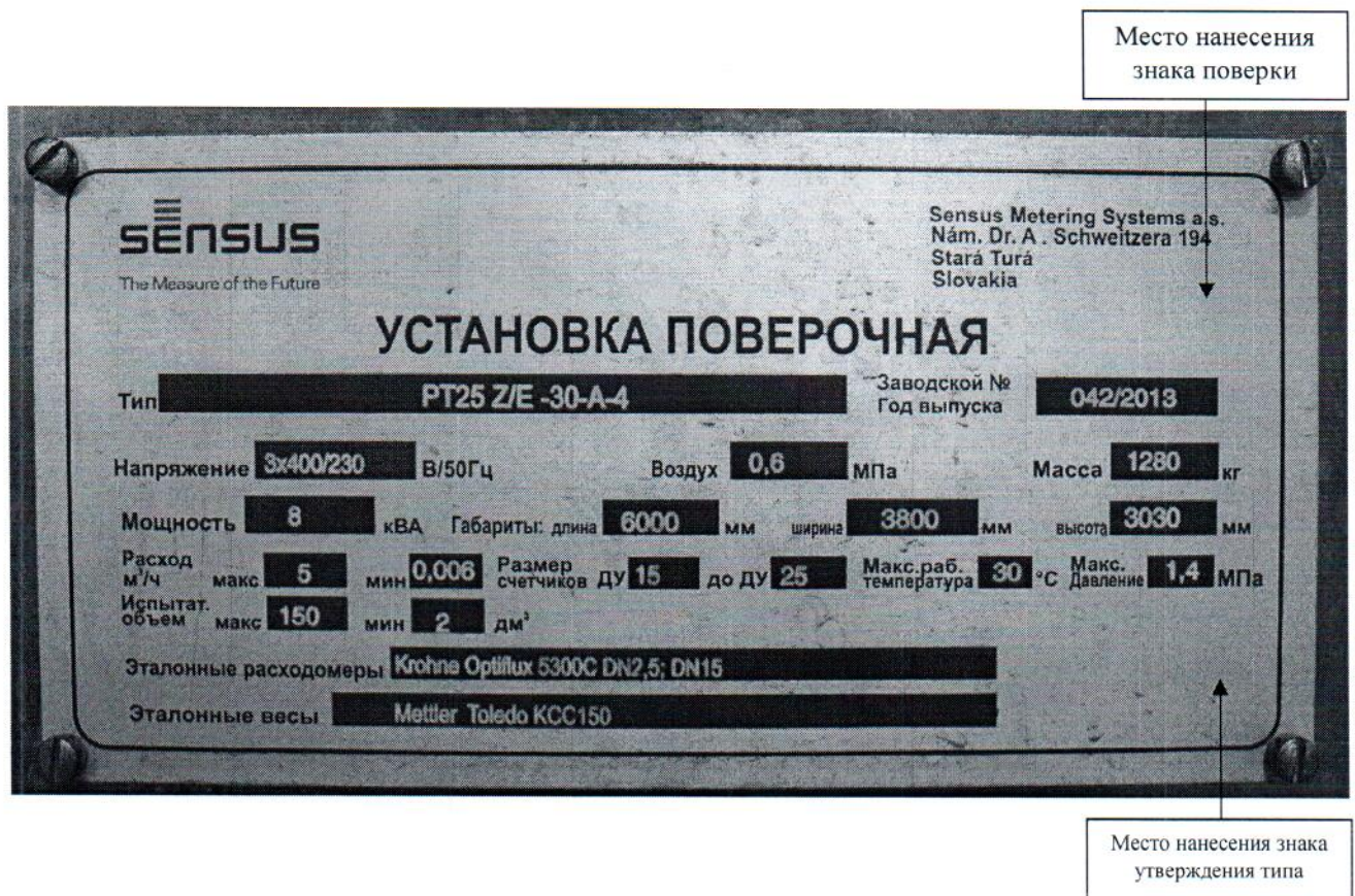
Рисунок 3 – Фотография маркировки установки и места нанесения знака поверки
