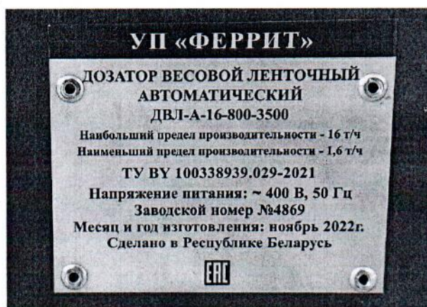
Рисунок 1.2 – Фотография маркировки дозатора весового ленточного автоматического ДВЛ-А-16-800-3500 № 4869
