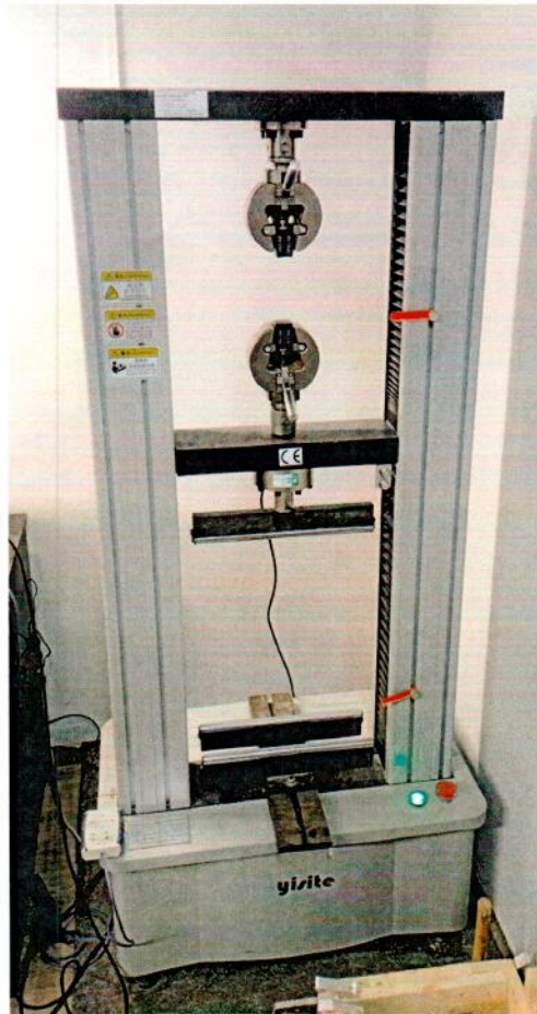
Рисунок 1.1 – Внешний вид универсальной электронной испытательной машины EWN-W20K № E2020721
