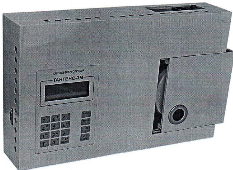
Рисунок 1 - Внешний вид автоматизированной установки измерения диэлектрических потерь трансформаторного масла ТАНГЕНС-3М
