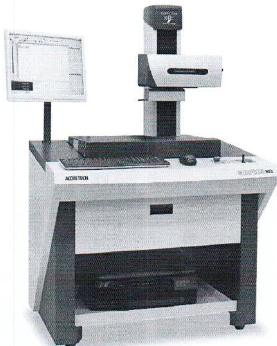
Рисунок 1.1 – Фотография общего вида прибора для измерения контура и параметров шероховатости поверхности SURFCOM NEX (изображение носит иллюстративный характер)
