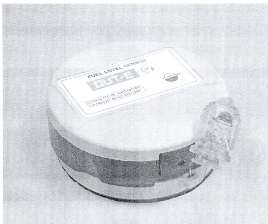
Рисунок 3.2 – Схема пломбировки от несанкционированного доступа
