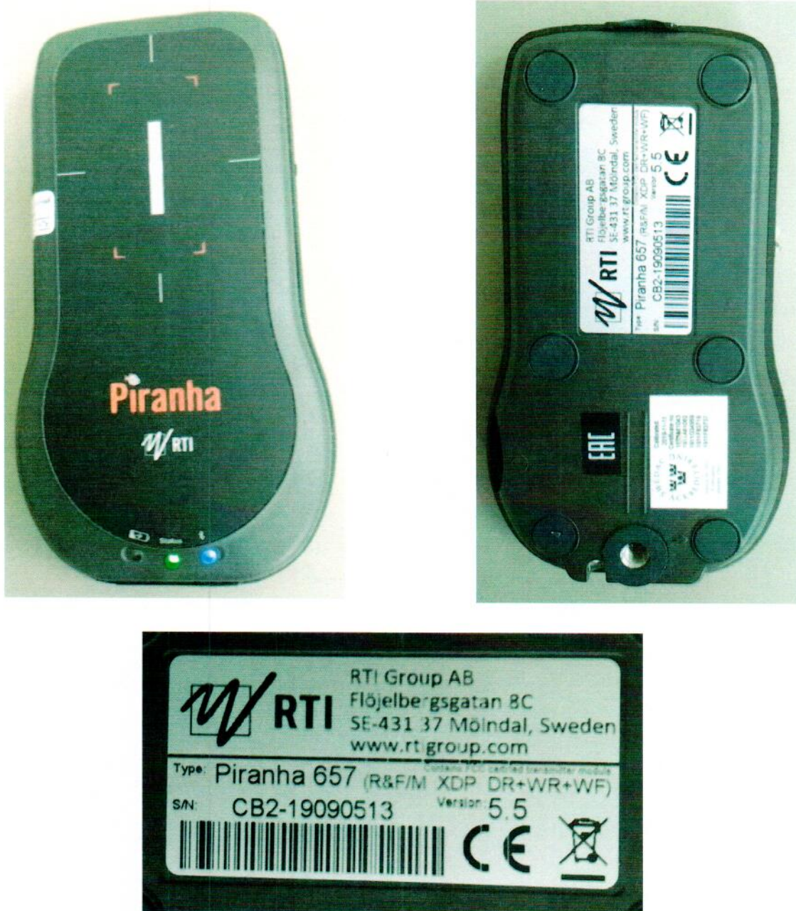
Рисунок 1.1 – Фотографии общего вида и маркировки дозиметра Piranha 657 № CB2-19090513
