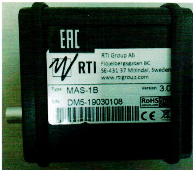
Рисунок 1.3 – Фотографии общего вида и маркировки внешнего детектора анодного тока MAS-1B № DM5-19030108
