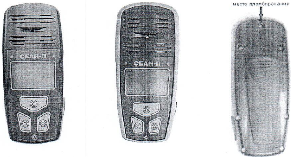
Рисунок 1 – Общий вид и схема пломбирования газоанализаторов СЕАН-П
