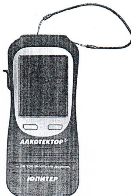
Рисунок 2 - Общий вид анализатора «АЛКОТЕКТОР» исполнение «ЮПИТЕР-К»
