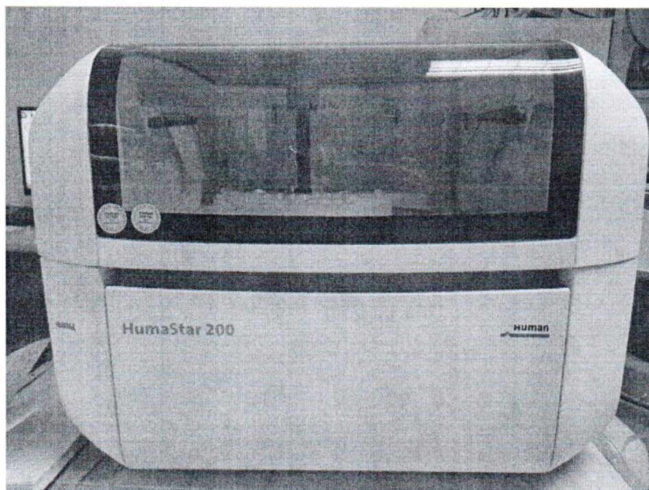
Рисунок 1.1 – Фотография общего вида анализатора биохимического автоматического с принадлежностями и материалами расходными: анализатор биохимический автоматический HumaStar 200 (изображение носит иллюстративный характер)
