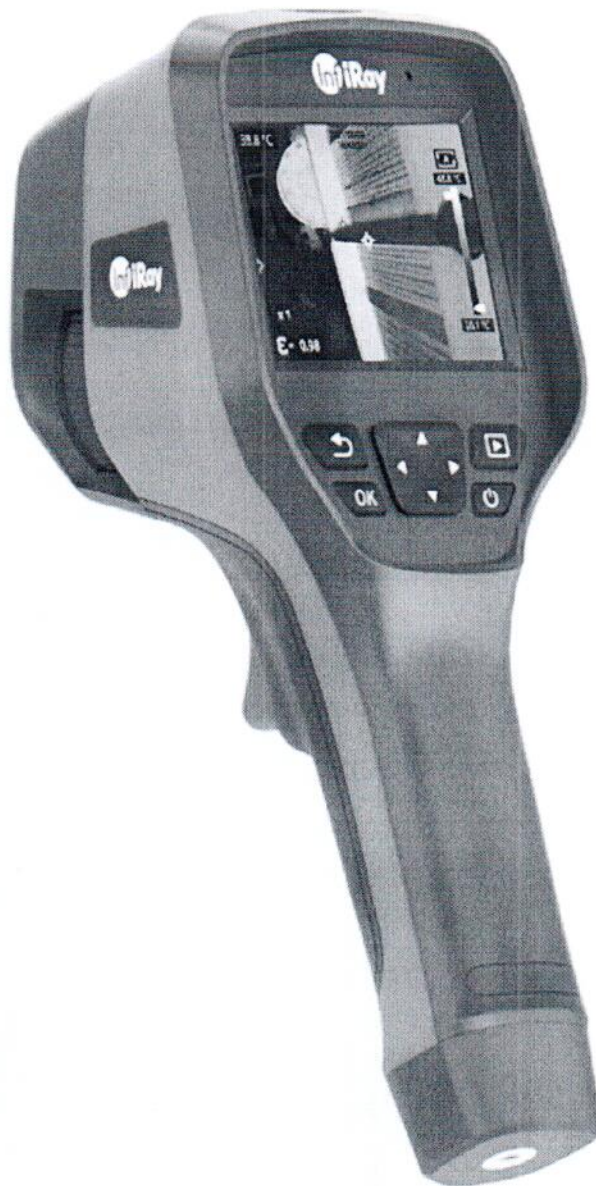
Рисунок 1.1 – Общий вид камер тепловизионных iRay M а) модификация M200A; б) модификации M200F, M300G, M600G, M620 (изображение носит иллюстративный характер)
