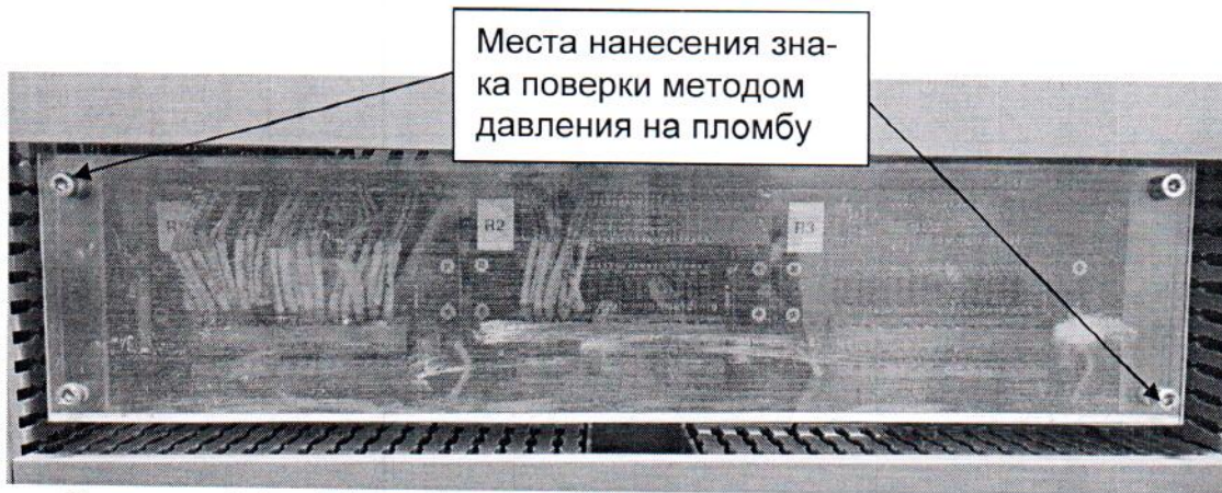
Рисунок 3.3 – Места пломбировки модуля токовых сигналов АИН-Р
