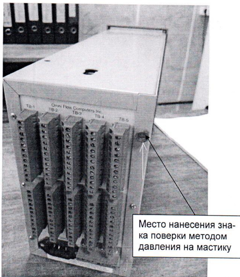
Рисунок 3.2 – Место пломбировки на задней поверхности
