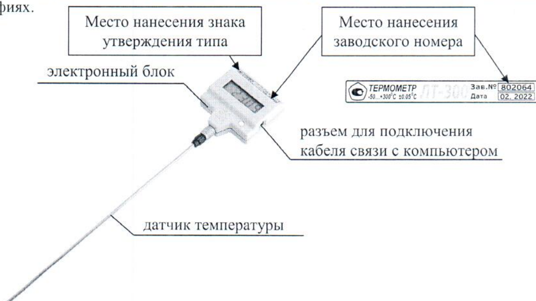
Рисунок 1 – Внешний вид термометра лабораторного электронного ЛТ-300 (модификаций -Н, -Т, -Ф) с непосредственным соединением датчика температуры к электронному блоку и с указанием мест нанесения знака утверждения типа и заводского номера
