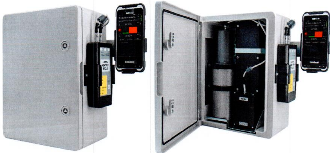
Рисунок 1.3 – Фотография общего вида спектрометров в рабочей упаковке «бокс» (изображение носит иллюстративный характер)
