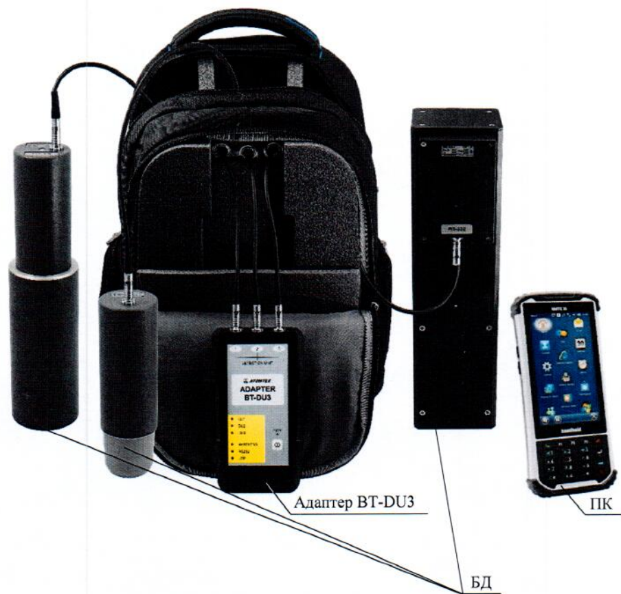
Рисунок 1.1 – Фотография общего вида спектрометров в рабочей упаковке «рюкзак» (изображение носит иллюстративный характер)
