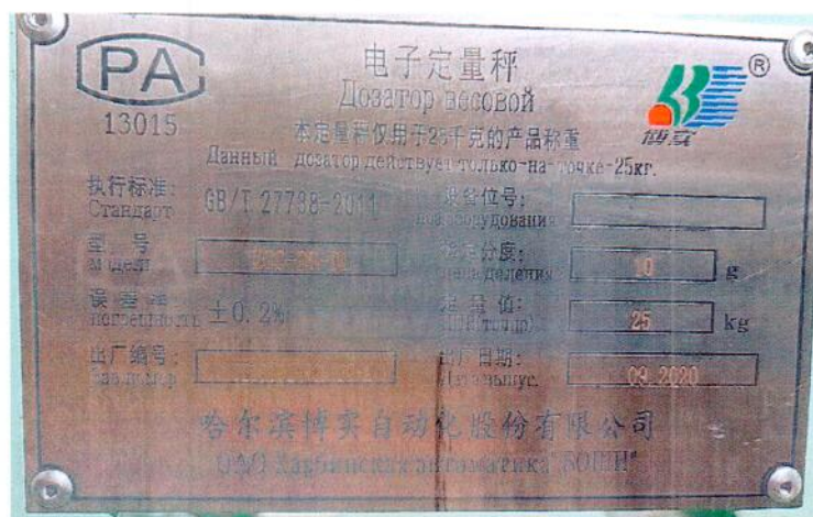
Рисунок 1.2 – Маркировка дозатора весового автоматического дискретного действия LCS-25-DL № CE19101-WCF.FC-A
