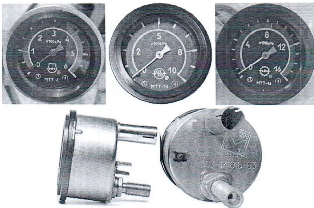
Рисунок 1.1 – Фотографии общего вида манометров технических тракторных МТТ (изображение носит иллюстративный характер)
