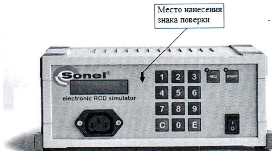
Рисунок 2.1 – Место нанесения знака поверки на калибратор времени отключения УЗО ERS-2 заводской № 161 на передней панели
