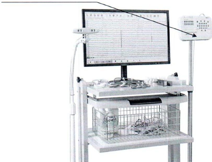
Рисунок 2.3 – Схема (рисунок) с указанием места для нанесения знака поверки на систему нейрофизиологическую «Нейрон-Спектр-63»
