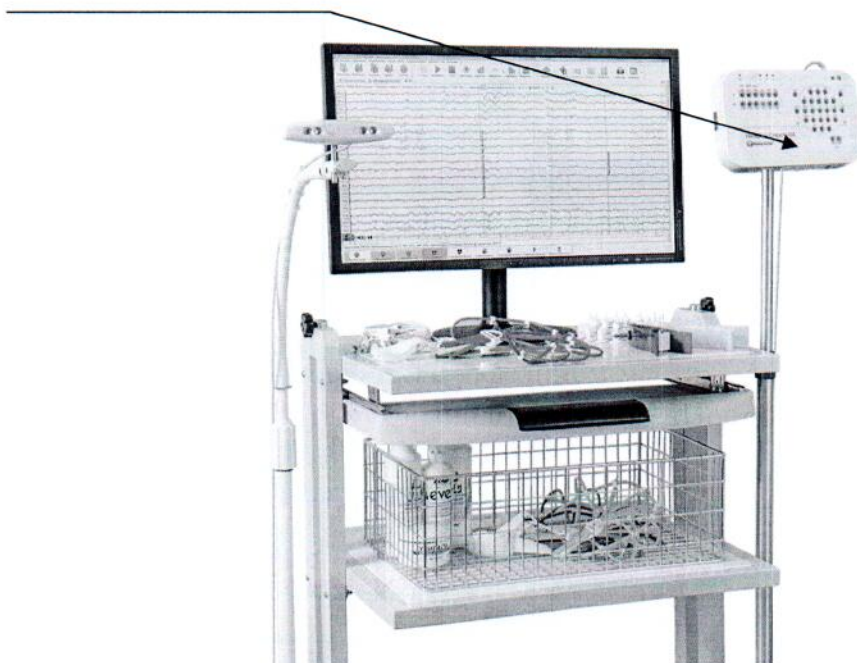
Рисунок 2.4 – Схема (рисунок) с указанием места для нанесения знака поверки на систему нейрофизиологическую «Нейрон-Спектр-64»
