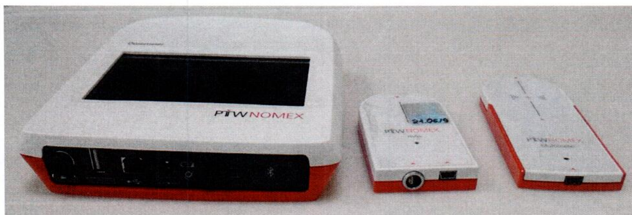
Рисунок 1.1 – Фотографии общего вида дозиметра NOMEX T11050 № 131135 в комплекте с датчиками NOMEX Multimeter T11049 № 101858 и NOMEX mAs T11060 № 160681
