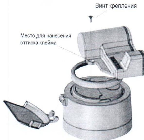
Рисунок 3.3 – Схема пломбировки EDC-модуля от несанкционированного доступа
