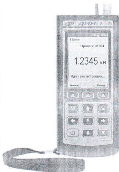
Рисунок 1 - Общий вид электронного блока динамометра
