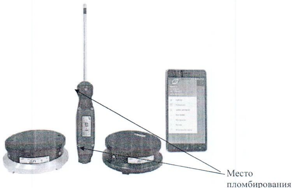
Рисунок 1 - Общий вид измерителя влажности ВИМС-3 и схема пломбировки от несанкционированного доступа.
