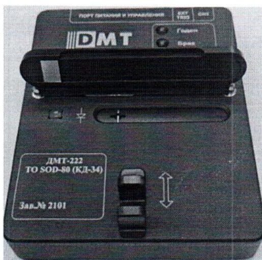
Рисунок 1.2 – Фотография маркировки комплекса измерительного для контроля заряда обратного восстановления Q_{вос} полупроводниковых диодов № 2101
