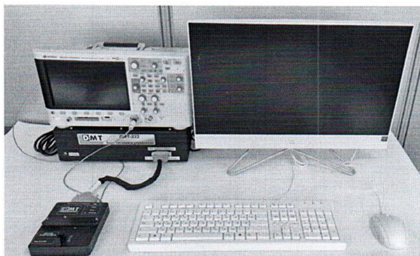
Рисунок 1.1 – Фотография общего вида комплекса измерительного для контроля заряда обратного восстановления Q_{вос} полупроводниковых диодов № 2101
