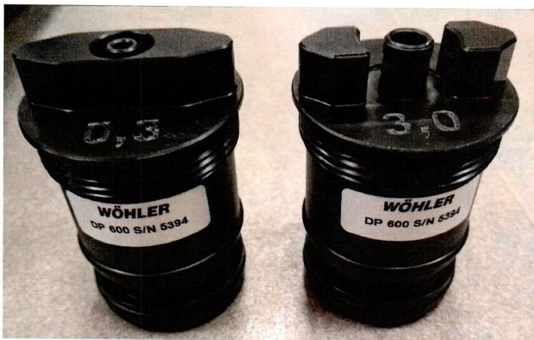
Рисунок 1.3 – Фотография общего вида и маркировки адаптеров «0,3» и «3,0» из комплекта прибора
