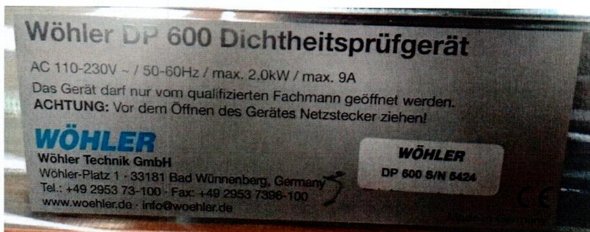
Рисунок 1.2 – Фотографии маркировки прибора
