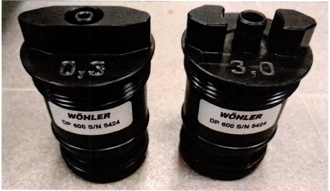
Рисунок 1.3 – Фотография общего вида и маркировки адаптеров «0,3» и «3,0» из комплекта прибора
