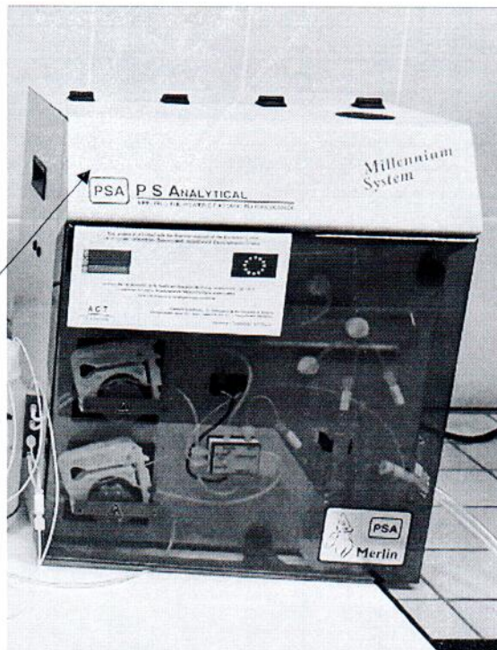
Рисунок 2.1 – Схема (рисунок) с указанием места для нанесения знака поверки средств измерений
