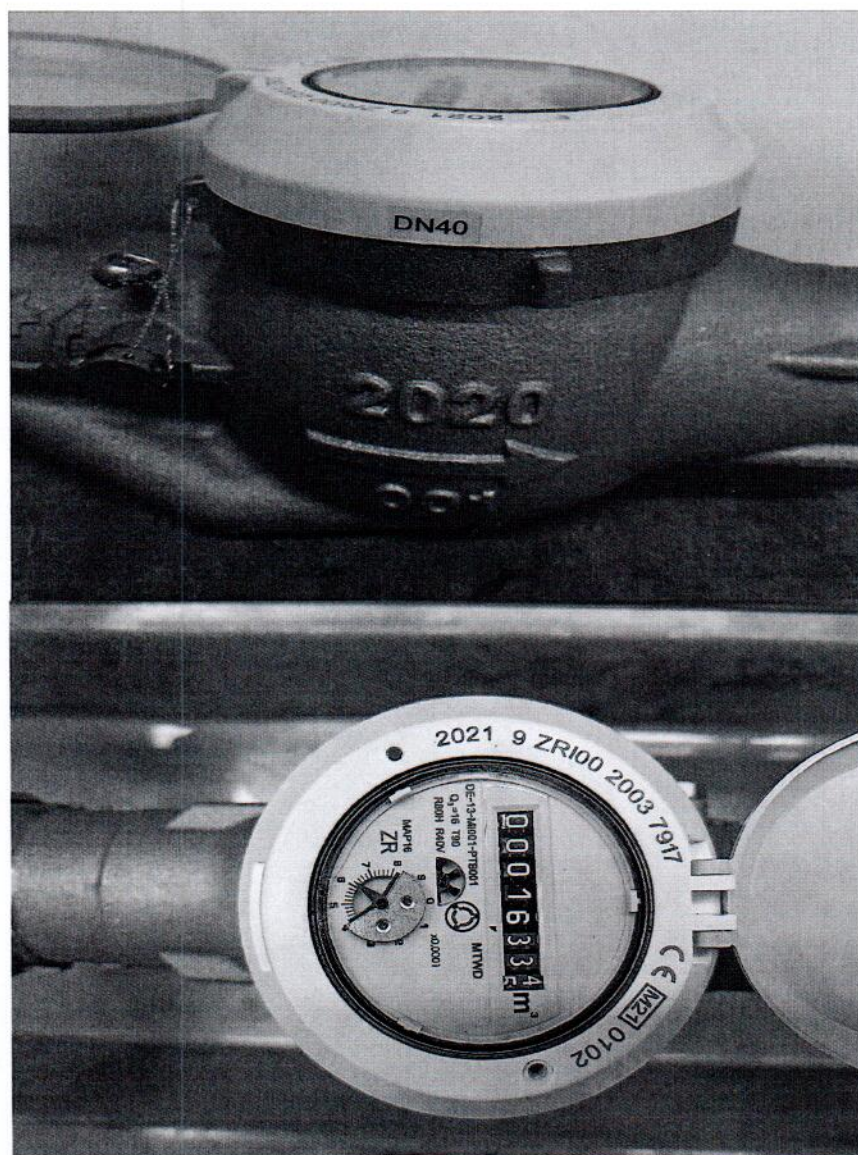
Рисунок 1.5 – Фотографии маркировки счетчиков горячей воды MTWD. Исполнение MTWD-M. (изображение носит иллюстративный характер)
