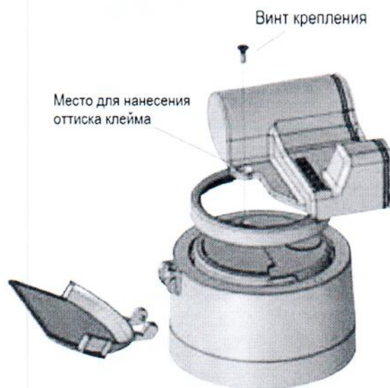
Рисунок 3.3 – Схема пломбировки EDC-модуля от несанкционированного доступа
