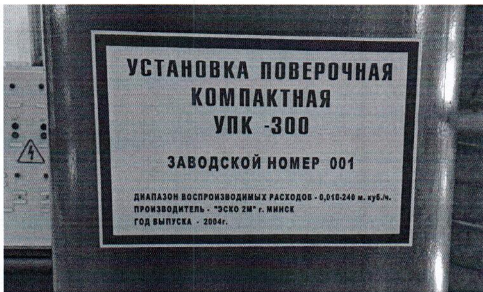
Рисунок 1.2 – Маркировка установки поверочной компактной УПК-300 №001
