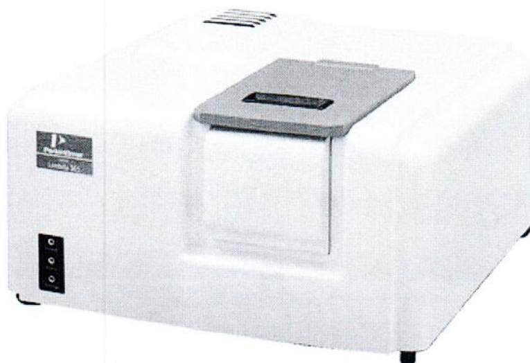
Рисунок 1.1 – Фотография общего вида спектрофотометра Lambda 365 № 365K8121103
