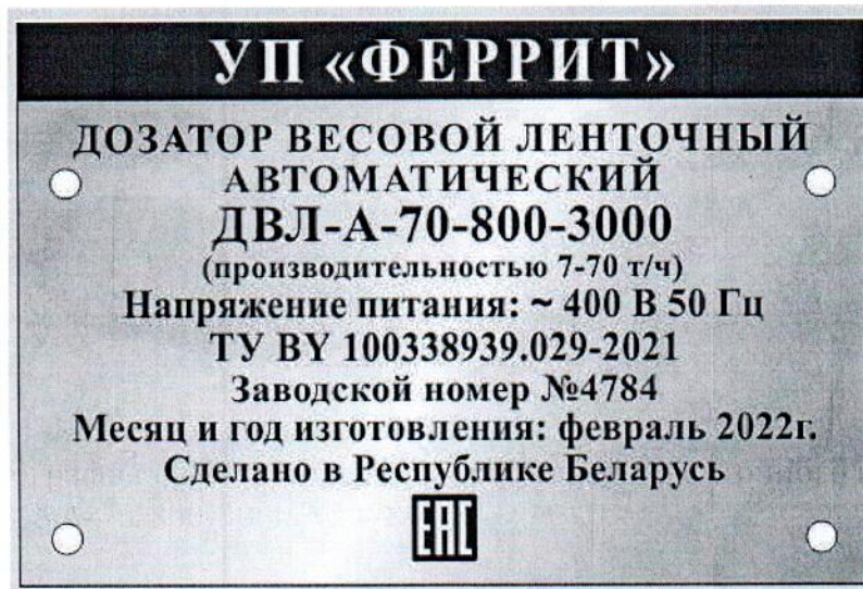
Рисунок 1.2 – Фотография маркировки дозатора весового ленточного автоматического ДВЛ-А-70-800-3000 № 4784
