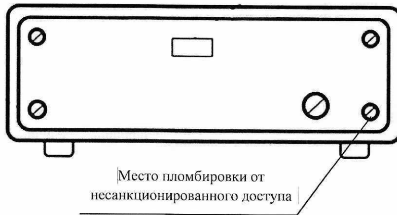
Рисунок 3.1 – Схема пломбировки от несанкционированного доступа
