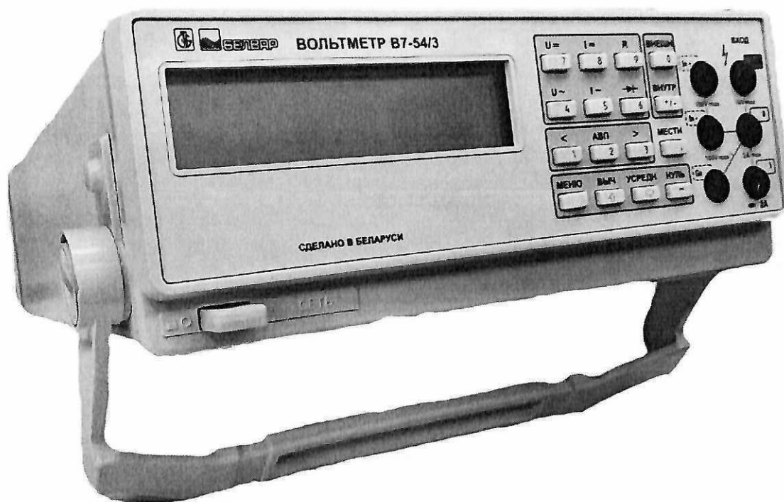
Рисунок 1.2 – Фотография общего вида вольтметра универсального В7-54/3
