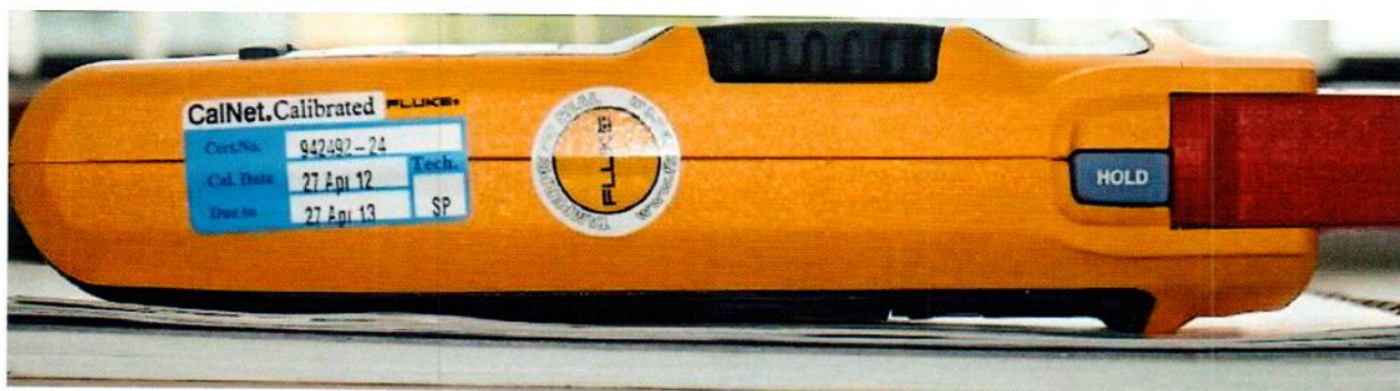
Рисунок 2 – Схема пломбировки от несанкционированного доступа
