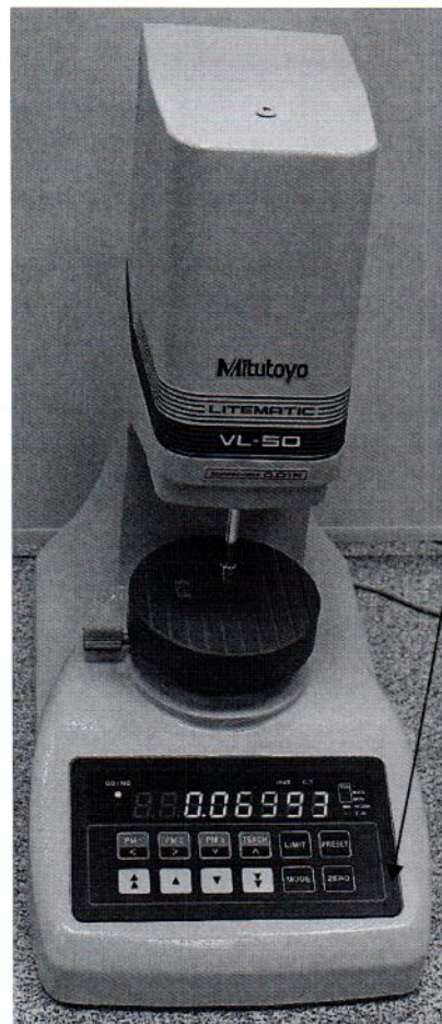
Рисунок 2.1 – Схема с указанием места для нанесения знака поверки
