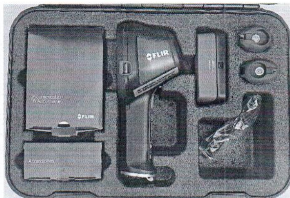
Рисунок 1.1 – Общий вид и маркировка камеры тепловизионной FLIR K65 № 72232580
