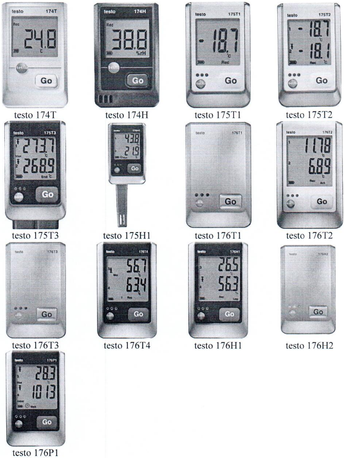
Рисунок 1.1 – Общий вид регистраторов температуры и относительной влажности testo 17x (изображение носит иллюстративный характер)
