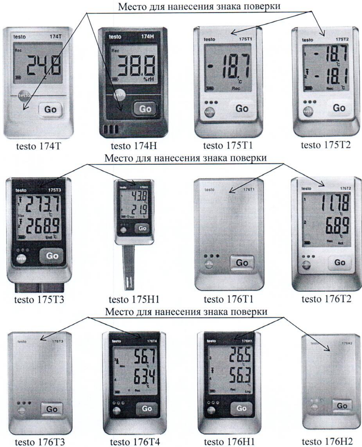
Рисунок 2.1 – Схема (рисунок) с указанием места для нанесения знака поверки средств измерений (изображение носит иллюстративный характер)
