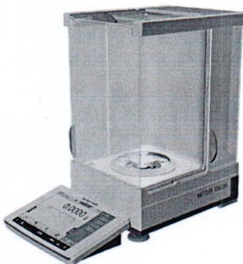
Рисунок 1.5 – Общий вид весов с действительной ценой деления 0,1 мг. Условное обозначение взвешивающего модуля: 204S, 404S, 504S
