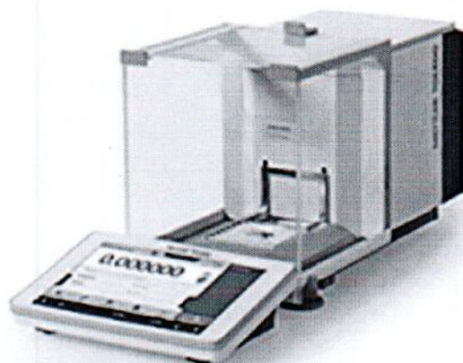
Рисунок 1.4 – Общий вид весов с действительной ценой деления 0,01 мг. Условное обозначение взвешивающего модуля 106Н
