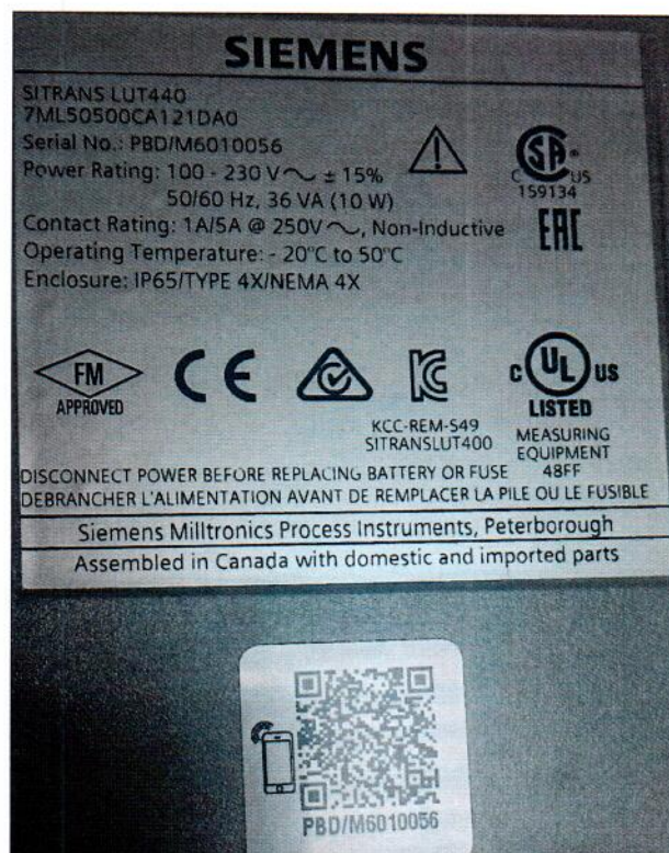
Рисунок 1.2 – Фотография маркировки уровнемера ультразвукового SITRANS LUT 440 № PBD/M6010056
