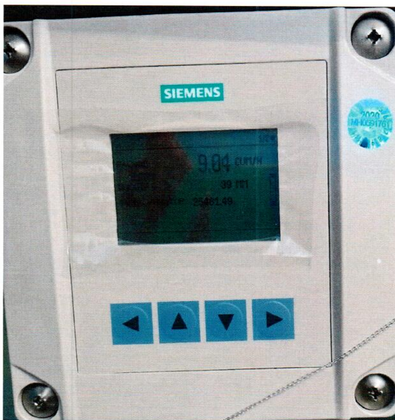
Рисунок 1.1 – Фотография общего вида уровнемера ультразвукового SITRANS LUT 440 № PBD/M6010056
