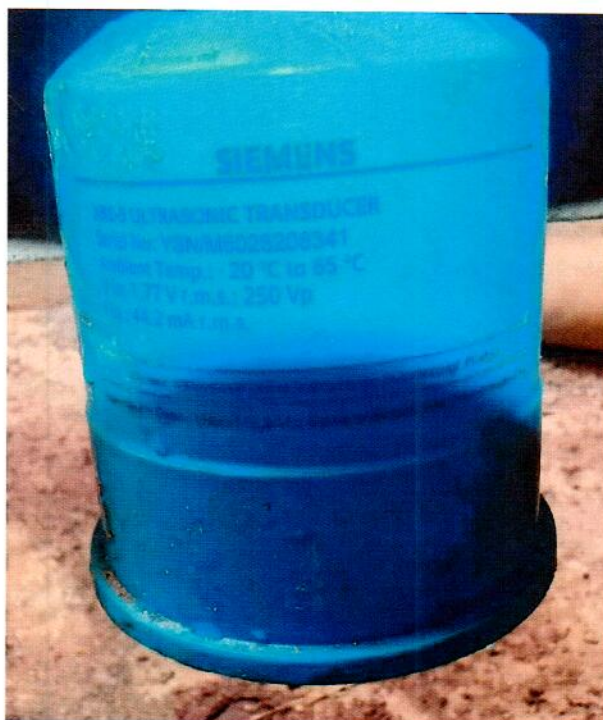
Рисунок 1.3 – Фотография общего вида ультразвукового преобразователя XRS-5 № YSN/M6028208341
