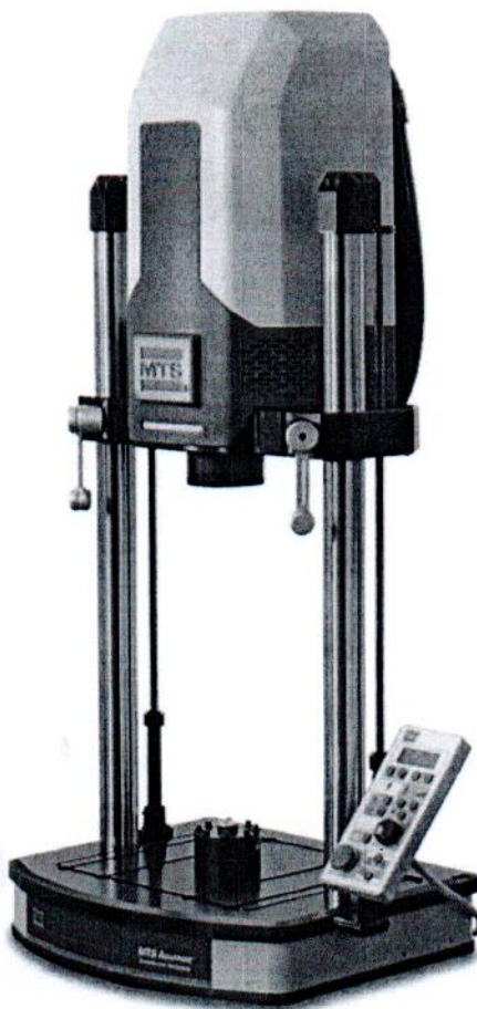
Рисунок 1.1 – Внешний вид машины настольной электродинамической для циклических испытаний MTS Acumen 3 807.003 № 10569479
