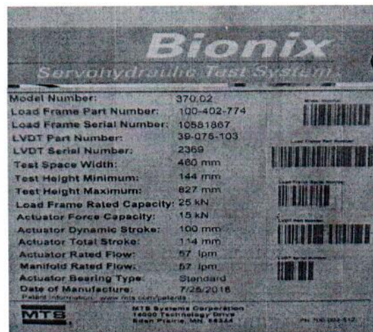
Рисунок 1.2 – Фотография маркировки машины настольной испытательной сервогидравлической MTS Bionix 370.02 № 10581867
