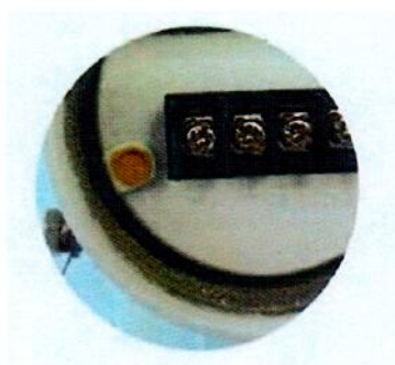
Рисунок 3 – Внутренняя гарантийная пломба на крышке клеммной колодки
