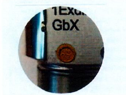
Рисунок 1 – Наружная пломба на стопорном винте, предотвращающем снятие корпуса электронного блока
