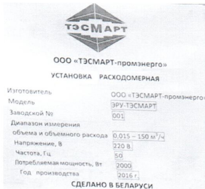
Рисунок 1.2 – Фотография маркировки установки расходомерной ЭРУ-ТЭСМАРТ № 001
