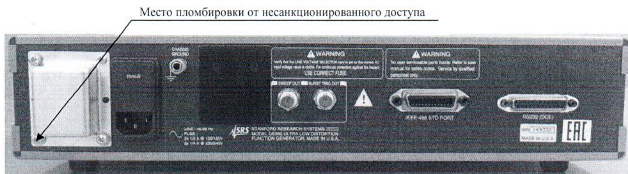
Рисунок 3.1 – Схема пломбировки от несанкционированного доступа
