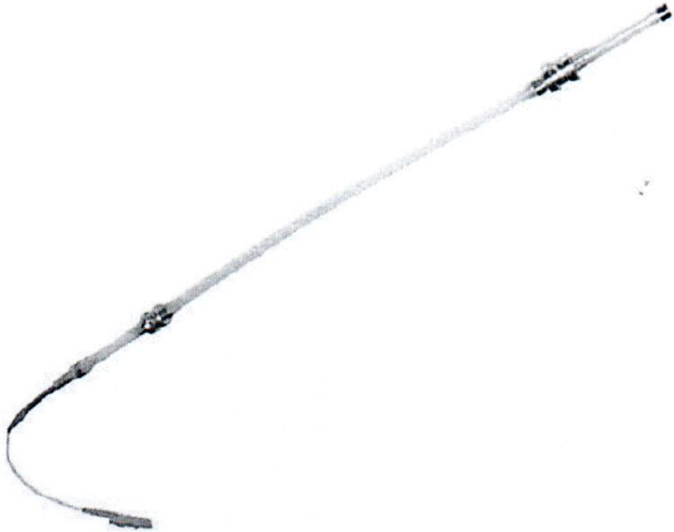
Рисунок 3 – Фотография общего вида волоконно-оптических датчиков Майкельсона SOFO
