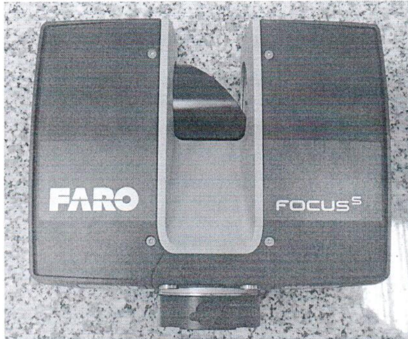
Рисунок 1.1 – Фотография общего вида лазерного сканера FARO Focus S70 № LLS081914642
