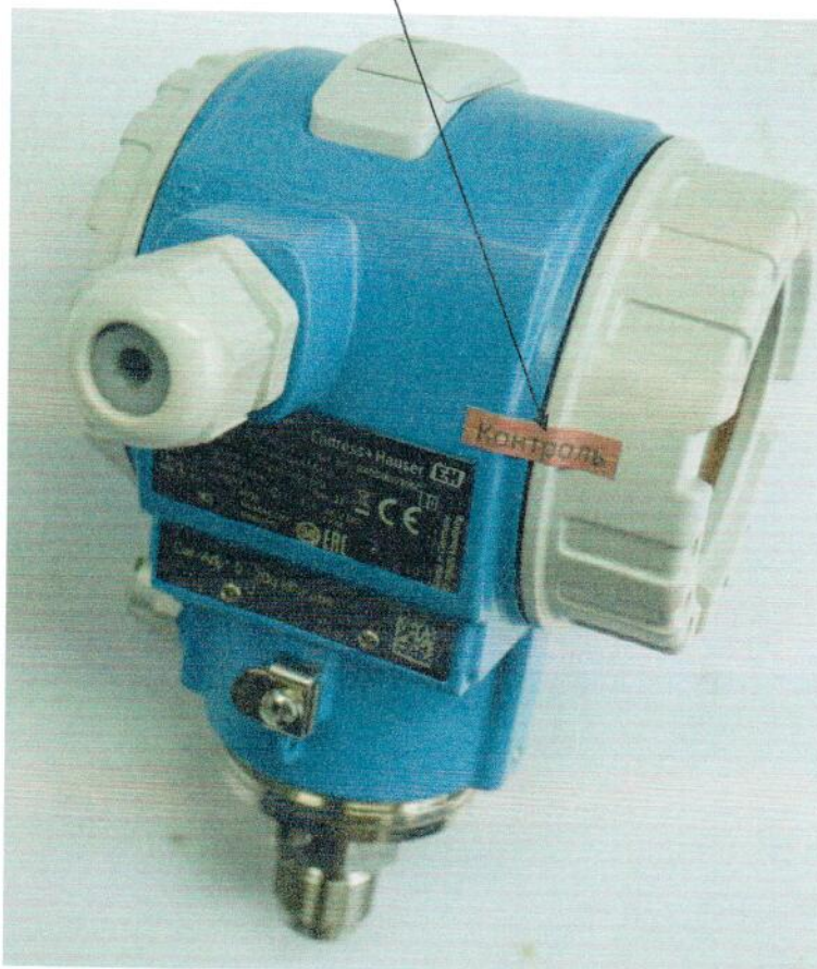
Рисунок 3.1 – Схема пломбировки от несанкционированного доступа
