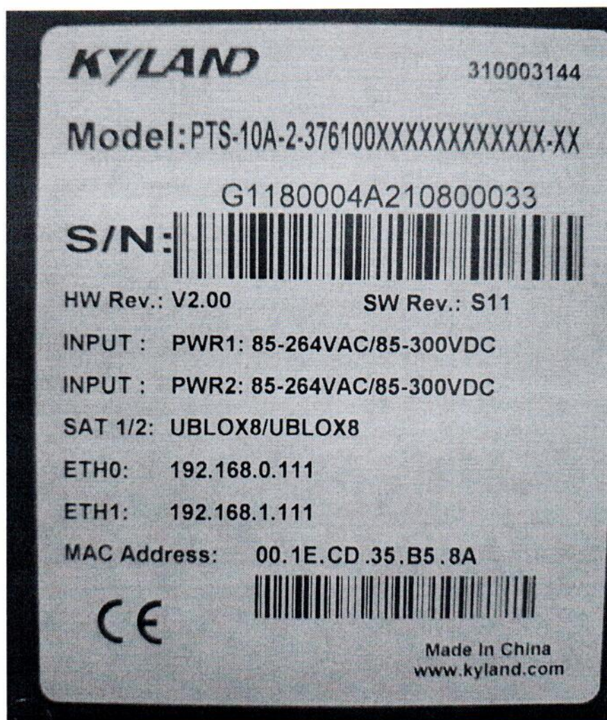
Рисунок 1.2 – Фотография маркировки сервера точного времени PTS-10A-2-376100XXXXXXXXXXXX-XX № G1180004A210800033
