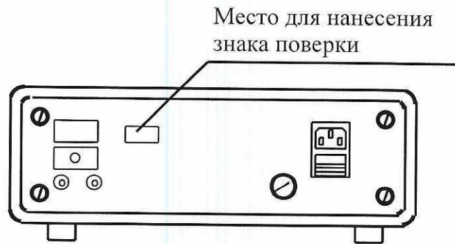
Рисунок 2.1 – Место для нанесения знака поверки типа средств измерений
