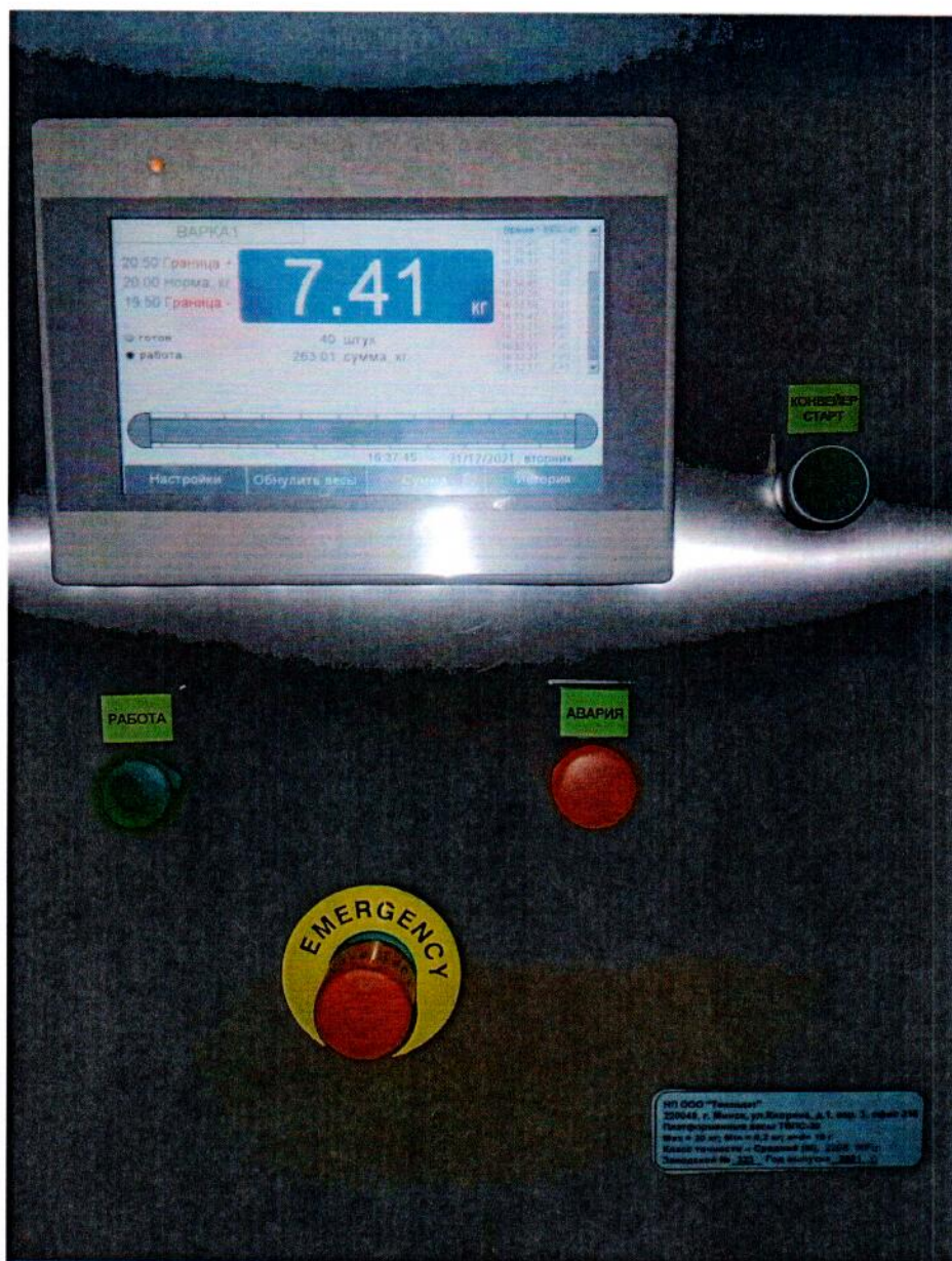
Рисунок А.2 – Внешний вид дискретного отсчётного устройства весов
